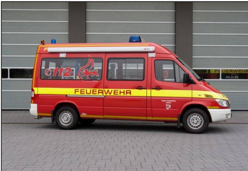
Der ELW besitzt eine umfangreiche Kommunikationsanlage, einen Lagetisch im Inneren, div. Messgeräte, und div. Führungsmittel (Einsatzunterlagen, Mobiltelefon). Er ist u.a. mit einer seitlichen Markise, Umfeldbeleuchtung und einer Fotoausrüstung ausgestattet. Das Fahrzeug wurde ursprünglich einmal als MTW angeschafft und dann zum ELW umgebaut.
