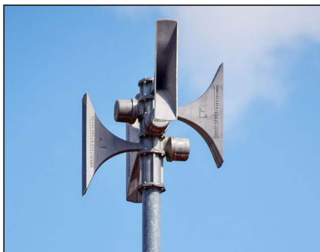
Links: Die mechanisch-pneumatische Motorsirene vom Typ SIEMENS E-57 war in Deutschland lange Zeit die meist verwendete Einheitssirene. Rechts: Elektronische Sirene vom Typ HÖRMANN ECI 600.
