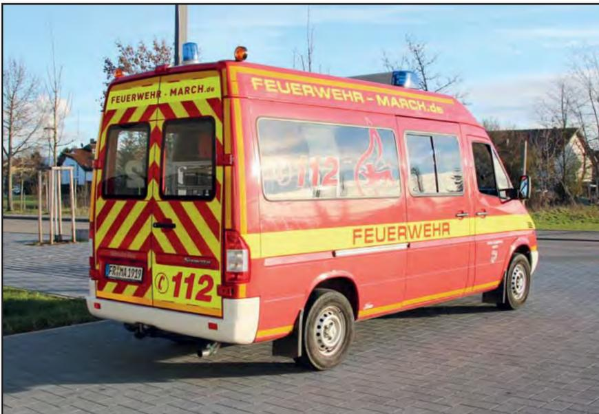
Der ELW besitzt eine umfangreiche Kommunikationsanlage, einen Lagetisch im Inneren, div. Messgeräte, und div. Führungsmittel (Einsatzunterlagen, Mobiltelefon, PC, Fax/Drucker). Er ist u.a. mit einer seitlichen Markise, Umfeldbeleuchtung und einer Fotoausrüstung ausgestattet. Das Fahrzeug wurde ursprünglich einmal als MTW angeschafft und dann zum ELW umgebaut.
