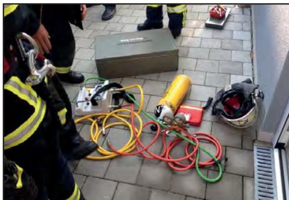
Service-Techniker des Aufzugs, entschloss man sich, die Fahrstuhltüre mit einem pneumatischen Hebekissen zu öffnen, was dann auch zu einer zügigen Befreiung der Insassen sowie des Tiers führte. Die Insassen befanden sich bis dahin bereits knapp 1,5 Stunden in ihrer misslichen Lage. Verletzt wurde niemand.
